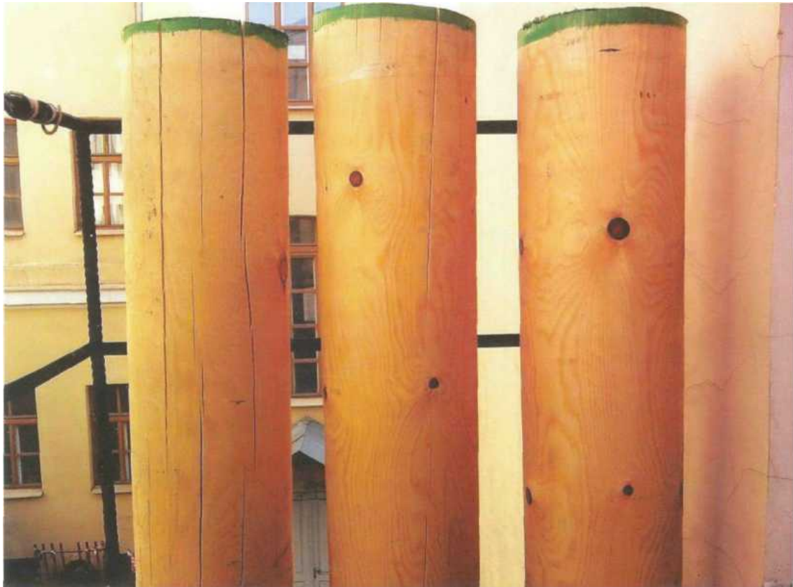
Abbildung 9. Zustand der Musterhölzer nach der Untersuchung (von links nach rechts: unbearbeitetes Muster, Muster mit 2-fachem Anstrich, Muster mit 3-fachem Anstrich)
