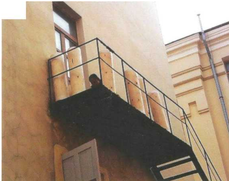
Abbildung 2: Lagerung der Musterhölzer
