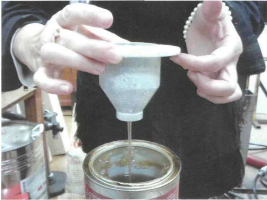
Abbildung 4. Messung der Viskosität 7 der verwendeten Anstrichstoffe
